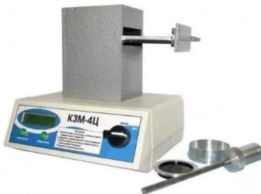
Прибор является фотоэлектрическим концентратомером взвешенных частиц в суспензиях.
