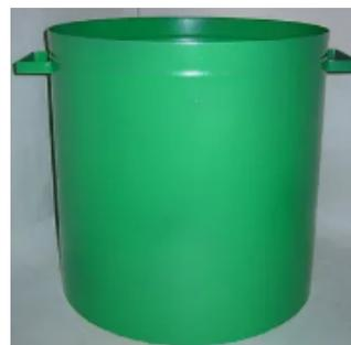
Мерная металлическая посуда **МП-20л** предназначена для определения насыпной плотности и пустотности по **ГОСТ 8269.0**.
