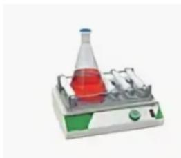
Перемешивающее устройство **ПЭ-6500** *предназначено* для перемешивания жидкостей в сосудах объемом от 100 до 1000 мл без подогрева.
