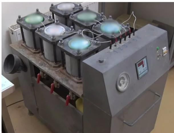
Установка **УВБ-МГ4** предназначена для испытания бетонных образцов-цилиндров на водонепроницаемость по методу «мокрого пятна» и коэффициенту фильтрации в соответствии с **ГОСТ 12730.5**.
