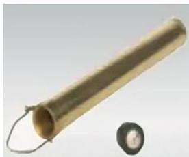
**Предназначен** для взятия проб нефтепродуктов и прочих жидкостей из резервуаров, емкостей, цистерн с глубины до 10 м, а также определения температуры и плотности пробы с помощью ареометра АНТ-1, АНТ-2 непосредственно на месте пробоотбора.
