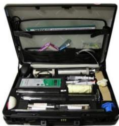
Лабораторный комплект **2М6У** для экспресс-анализа топлив **предназначен** для отбора проб и проведения приемо-сдаточного анализа горюче-смазочных материалов.
