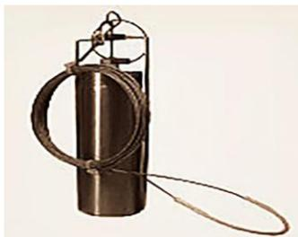
**Пробоотборник переносной предназначен** для отбора проб (в том числе и донных) нефтепродуктов и специальных жидкостей из автомобильных и железнодорожных цистерн, стационарных резервуаров высотой до 3,5 (5) м. Разработан и изготовлен в соответствии с требованиями ГОСТ 2517-85 "Нефть и нефтепродукты. Методы отбора проб".
