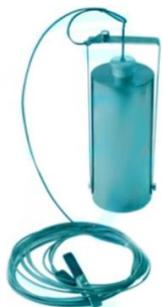
**Пробоотборник переносной предназначен** для отбора проб (в том числе и донных) нефтепродуктов и специальных жидкостей из автомобильных и железнодорожных цистерн, стационарных резервуаров высотой до 3,5 (5) м. Разработан и изготовлен в соответствии с требованиями ГОСТ 2517-85 "Нефть и нефтепродукты. Методы отбора проб".
