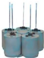
Аппарат для определения температуры текучести и застывания нефтепродуктов предназначен для обеспечения проведения испытаний в соответствии с методиками, изложенными в ГОСТ 20287-91. Применяется в лабораториях НПЗ, НИИ и других организациях, использующих нефтепродукты.
