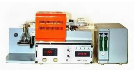
Прибор *предназначен* для сжигания массы анализируемых образцов нефтепродуктов при температуре 900-950°C, с последующим поглощением продуктов сгорания и определением массовой доли серы методом титриметрии.
