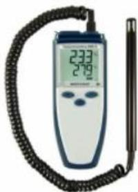
Прибор *предназначен* для измерения и регистрации относительной влажности и температуры воздуха в жилых, складских и производственных помещениях, а также в свободной атмосфере.
