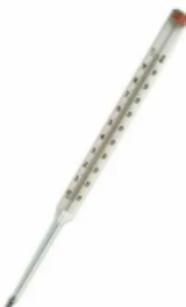
Термометр тип ТТ (Термометр Технический) ртутный предназначен для местного контроля температуры в трубопроводах, сосудах и других промышленных установках.
