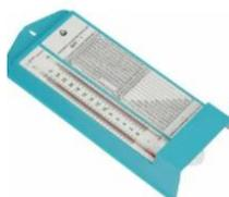
Прибор предназначен для измерения относительной влажности и температуры воздуха в помещении.
