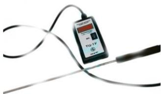
Прибор предназначен для измерения температуры не агрессивных жидкостей и газов, а также твёрдых тел в различных отраслях промышленности, медицины и сельского хозяйства.
