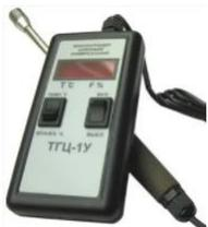
Прибор **предназначен** для измерения влажности воздуха в диапазоне 0 ... 100% и температуры неагрессивных газов в диапазоне -55 ... +85°C, в различных отраслях промышленности, медицине и сельском хозяйстве.
