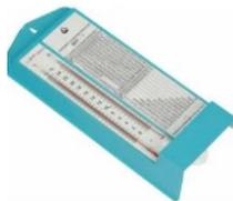
Измерение относительной влажности и температуры воздуха в помещении.
