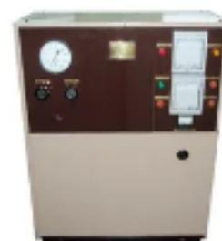
Установка предназначена для определения сроков схватывания тампонажных растворов.
