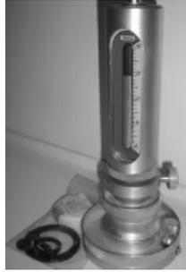
Прибор **ВМ-6** предназначен для определения водоотдачи глинистых растворов, применяемых при бурении нефтяных и газовых скважин, а также для определения толщины глинистой корки, образующейся на фильтре. Водоотдача измеряется количеством фильтрата в см куб., выделяющегося при избыточном давлении ( $0,1 \pm 0,01$ ) МПа, ( $1 \pm 0,1$ ) кг/см кв. за 30 мин. с площади фильтрации диаметром 75 мм.
