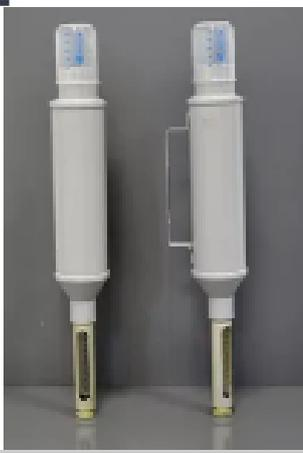
**Отстойник ОМ-2** предназначен для определения содержания песка в глинистых растворах, применяемых при бурении нефтяных и газовых скважин. Отстойник может использоваться как в помещении, так и на открытом воздухе под навесом.
