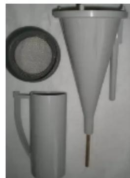
Вискозиметр бурового раствора **ВБР-2** (в дальнейшем-вискозиметр) предназначен для определения вязкости буровых растворов, применяемых при бурении нефтяных и газовых скважин и любых скважин другого назначения.
