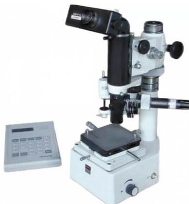
Микротвердомер ПМТ-3М *предназначен* для измерения микротвердости материалов, сплавов, стекла, керамики и минералов методом вдавливания в испытуемый материал алмазного наконечника **Виккерса** с квадратным основанием четырехгранной пирамиды, обеспечивающей геометрическое и механическое подобие отпечатков по мере углубления индентора под действием нагрузки.
