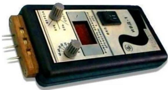
**Прибор предназначен** для оперативного определения влажности пиломатериалов, заготовок, деталей и изделий из химически необработанной древесины: сосны, ели, березы и бука европейской зоны произрастания.
