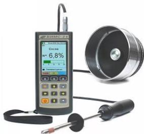
**Влагомеры серии ВИМС-2.21** предназначены для оперативного контроля влажности твёрдых и сыпучих материалов, в том числе:
