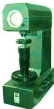
Твердомер 2109 ТБ применяется для измерения твердости металлов по Бринеллю и обеспечения разбраковки изделий на группы твердости.
