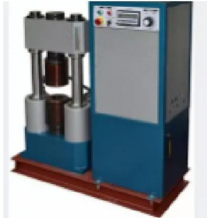
Машина испытательная РМ-50М (500 кН/50т) для испытания сварных соединений
