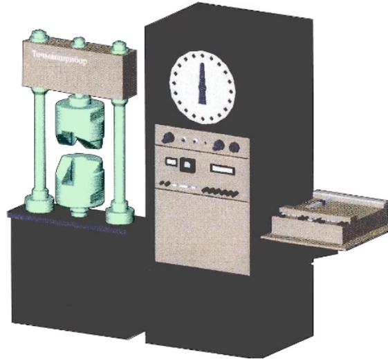
Разрывная машина ИР-100-0 (10т) для статических испытаний.
