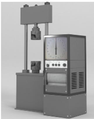
Разрывная машина ИР-200-0 (200кН/20т) для статических испытаний.
