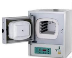
**Печь предназначена** для выполнения лабораторных аналитических работ; выплавки и выжига восковых моделей из литейных форм, обжига литейных форм, термической и высокотемпературной обработки материалов и металлов в воздушной среде, обжига керамических изделий, прокаливания, отпуска и отжига изделий и материалов, плавки и пайки цветных металлов, изготовление ювелирных и сувенирных изделий.
