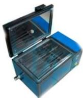
**Бачок БК-2 предназначен** для проведения испытаний цемента на равномерность изменения объема по ГОСТ 310.3.
