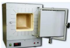
Муфельные печи серии ПМ *предназначены* для термической обработки металлов, керамики, реактивов и прочих материалов. Используются в лабораториях производств, в ювелирном и сувенирном производстве, в медицине и других областях.
