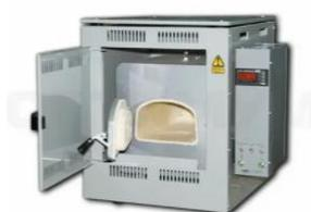
**Муфельные печи серии ПМ предназначены** для термической обработки металлов, керамики, реактивов и прочих материалов. Используются в лабораториях производств, в ювелирном и сувенирном производстве, в медицине и других областях.
