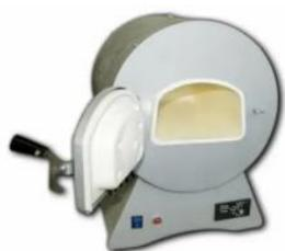
Муфельные печи серии ПМ **предназначены** для термической обработки металлов, керамики, реактивов и прочих материалов. **Используются** в лабораториях производств, в ювелирном и сувенирном производстве, в медицине и других областях.
