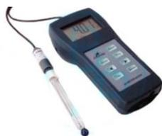
**Предназначен** для измерения активности ионов водорода (рН), окислительно-восстановительного потенциала (Еh) и температуры водных растворов.
