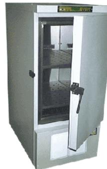
Камера тепла и холода - КТХ для испытания бетона, раствора, щебня, кирпича на морозостойкость, по ГОСТ 10060-2012, ГОСТ 8269.0-97, ГОСТ 5802-86.
