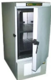
Морозильная камера - МК предназначена для испытания образцов бетона, раствора, щебня, кирпича на морозостойкость по ГОСТ 10060-2012, ГОСТ 8269.0-97, ГОСТ 5802-86, а так же для испытаний любых материалов на морозостойкость, в пределах своих технических характеристик.
