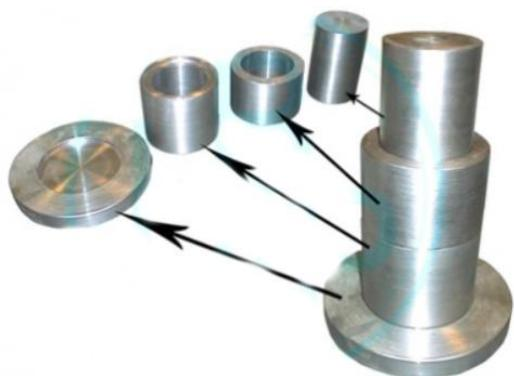
Форма *предназначена* для определения плотности (объемной массы) минерального порошка для испытания асфальтобетонных смесей в лабораторных условиях по **ГОСТ Р 52129-2003**.
