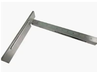
Устройство **предназначено** для определения высоты выступания горизонтальной дорожной разметки над поверхностью, на которую она нанесена. Контроль высоты выступания осуществляется клиновым высотометром для горизонтальной дорожной разметки, выполненной термопластичными, холодными пластичными, штучными формами и полимерными лентами.
