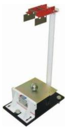
Прибор **Виалита ПВ-01** для оценки полной и активной адгезии щебня и вяжущего при устройстве шероховатой поверхностной обработки (ШПО).
