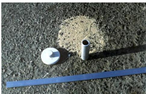
Приспособление используется при контроле состояния дорожного после устройства или в процессе эксплуатации по методике, описанной в **СНиП 3.06.03-85**.
