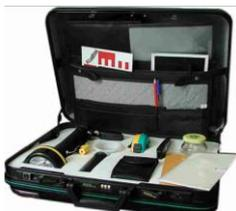
**Комплект КПДР-1 предназначен** для проведения операционного, приемочного и эксплуатационного контроля качества дорожной разметки выполненной различными маркировочными материалами.
