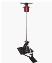
**Прибор ИКСП-м предназначен** для измерения коэффициента сцепления дорожных покрытий при строительстве и ремонте автомобильных дорог, периодическом и текущем контроле состояния дорожных покрытий.
