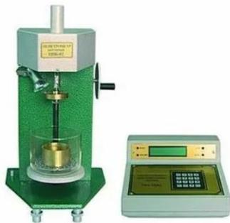
**ПНБ-03 предназначен** для определения пенетрации нефтяных битумов путем автоматического измерения глубины погружения в испытуемый образец стандартной по массе, форме и размерам иглы (ГОСТ 11501) при заданной температуре в течение заданного времени.
