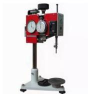
Пенетрометр КП-154С *предназначен* для контроля качества битумных вяжущих при приготовлении асфальтобетонных и битумоминеральных смесей путем определения вязкости (пенетрации) дорожных битумов по ГОСТ 11501-78.
