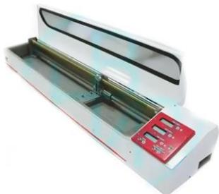
Определяет дуктильность (величину растяжения) образцов нефтяных и модифицированных битумов.
