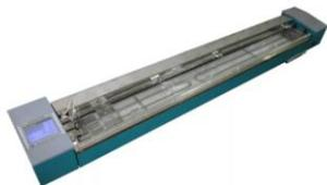
Аппарат автоматический **Линтел ДБ-20-150** для определения растяжимости нефтяных битумов
