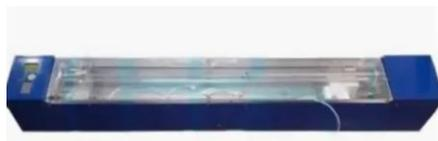
Дуктилометр битумный **ДБС-1000** *предназначен* для измерения растяжимости битума и максимального усилия при растяжении испытуемых образцов в соответствии с требованиями **ГОСТ 33138-2014**.
