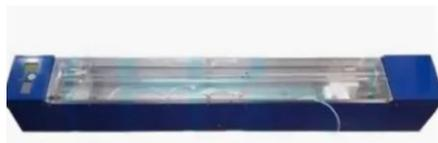
Дуктилометр битумный **ДБС-1500** *предназначен* для измерения растяжимости битума и максимального усилия при растяжении испытуемых образцов в соответствии с требованиями **ГОСТ 33138-2014**.
