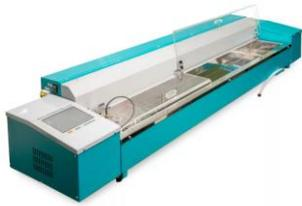
Аппарат автоматический **Линтел ДБ-20-100** для определения растяжимости нефтяных битумов
