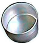
**Применяется** для измерения пенетрации (глубины проникновения иглы) в битуме по **ГОСТ 11501-78** (СТ СЭВ 3658-82). Чашка металлическая цилиндрическая с плоским дном, внутренней высотой  $60 \pm 1$  мм применяется для битумов с глубиной проникания иглы до 250 мм.
