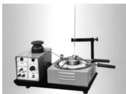
**Аппарат предназначен** для испытания нефтепродуктов с целью определения температуры вспышки в открытом тигле по методу **ГОСТ 4333 и ISO 2592**.
