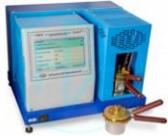
**Аппарат предназначен** для определения температуры вспышки в закрытом тигле. Прибор реализует метод Пенского-Мартенса (Pensky-Martens) - ГОСТ 6356-75, ГОСТ Р ЕН ИСО 2719-2008, ISO 2719-88 (А), ASTM D 93. В соответствии с **МИ 2418-97 "Классификация и применение технических средств испытаний нефти и нефтепродуктов"**, зарегистрированной Госстандартом России 15.12.97 г., аппарат рекомендован для определения температуры вспышки нефтепродуктов в закрытом тигле.
