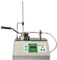
**Предназначен** для определения температуры вспышки нефтепродуктов в открытом тигле в соответствии с методом **А ASTM D92** и **ГОСТ 4333-87**
