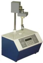
**АТХ-03 предназначен** для охлаждения рабочей пластины с нанесенным на нее слоем битума при периодическом ее сгибании и распрямлении и определения температуры, при которой на битуме появляются трещины или происходит излом образца.
