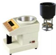
Прибор ИКШ-МГ4 *предназначен* для определения температуры размягчения нефтебитумов по **ГОСТ 11506-73** в соответствии с **МИ 2418**.
