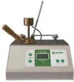
**Аппарат предназначен** для быстрого и точного определения показателей температуры вспышки нефтепродуктов (а также масла растительного) в закрытом тигле в соответствии с методом **В ASTM Д93** и **ГОСТ 6356-91 (ГОСТ 9287-59 Масла растительные)**.
