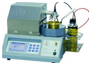
Автоматический аппарат ТВО-ЛАБ-11 *предназначен* для определения температуры вспышки в открытом тигле по методу Кливленда в соответствии с ГОСТ 4333-87, ISO 2592, ASTM D 92.
