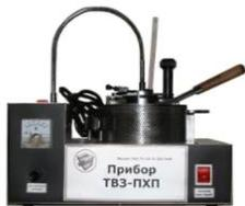
**Аппарат ТВЗ предназначен** для определения температуры вспышки нефтепродуктов в закрытом герметичном тигле, в соответствии с **ГОСТ 6356**.
