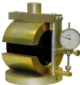
Обжимное устройство *предназначено* для определения сопротивления пластическому течению асфальтобетона при сжатии *по схеме Маршалла*, на стандартных цилиндрических образцах диаметром **101,6 мм**, на прессе по ПНСТ 109-2016.
