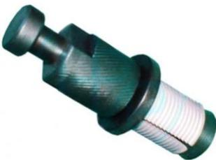
**Анкер предназначен** для испытания бетона методом отрыва со скалыванием по **ГОСТ 22690-2015**.
