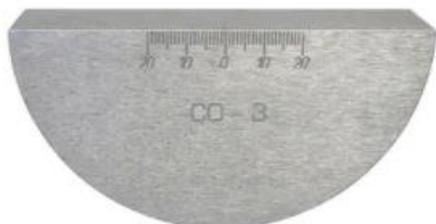
**Стандартный образец СО-3 применяют** для определения точки выхода ультразвукового луча и стрелы преобразователя ультразвукового дефектоскопа. Может применяться для определения времени распространения ультразвуковых колебаний в призме преобразователя.
