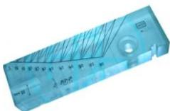
**Стандартный образец СО-1 предназначен** для определения условной чувствительности, проверки разрешающей способности и погрешности глубиномера ультразвукового дефектоскопа.
