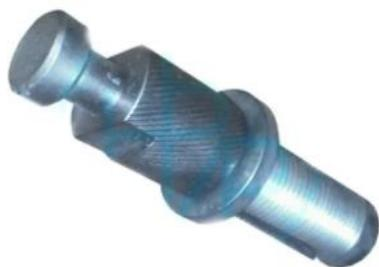
**Анкер предназначен** для испытания бетона методом отрыва со скалыванием по **ГОСТ 22690-88**. Применяется с приборами **ПИБ (70кН/7тс)**.
