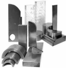
Комплект стандартных образцов **КОУ-2М по ГОСТ 14782-86** *предназначен* для определения основных параметров ультразвукового контроля сварных соединений
