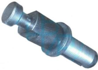
**Анкер предназначен** для испытания бетона методом отрыва со скалыванием по **ГОСТ 22690-88**.
