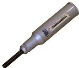
**Склерометр предназначен** для определения прочности бетона на сжатие **в диапазоне от 5 до 40 МПа** в бетонных и железобетонных конструкциях и изделиях методом упругого отскока по **ГОСТ 22690**.
