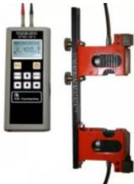
Дефектоскоп **предназначен** для контроля качества сварных стыковых соединений стержней арматуры диаметром от 20 до 80 мм по **ГОСТ 23858-79** при монтаже сборных и возведении монолитных ж/б конструкций теньвым и зеркально-теньвым методом.
