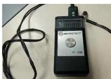
**Предназначен** для измерения толщины стальных изделий эхо-импульсным методом.
