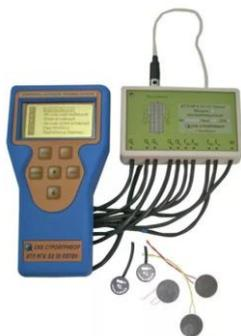
**ИТП-МГ4.03/10(I) «Поток» предназначен** для измерения и регистрации плотности тепловых потоков, проходящих через однослойные и многослойные ограждающие конструкции зданий и сооружений по **ГОСТ 25380**, через облицовку и теплоизоляцию энергообъектов при экспериментальном исследовании и в условиях эксплуатации.
