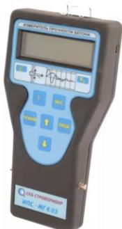
Прибор ИПС-МГ4.03 *предназначен* для оперативного неразрушающего контроля прочности и однородности бетона и раствора методом ударного импульса по **ГОСТ 22690**.
