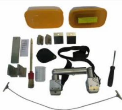
Дефектоскоп **предназначен** для выявления поверхностных дефектов типа нарушения сплошности металла магнто-порошковым методом на локальных участках крупногабаритных деталей способом приложенного поля.
