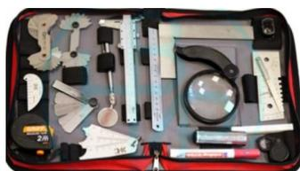
**Комплекты ВИК применяются** для визуального и измерительного контроля основного металла и сварных соединений на стадиях входного контроля, подготовки к сварке и оценки их состояния в ходе эксплуатации.
