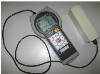
**Прибор предназначен** для контроля толщины защитного слоя бетона и расположения арматуры в железобетонных изделиях магнитным методом в соответствии с **ГОСТ 22904-93**.
