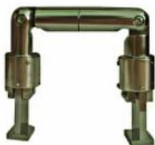
**Прибор предназначен** для выявления поверхностных дефектов типа нарушения сплошности металла магнитопорошковым методом на локальных участках крупногабаритных деталей путем создания приложенного постоянного магнитного поля.
