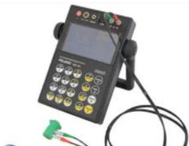
**Прибор предназначен** для контроля сплошности сварных соединений листовых элементов, труб, котлов, рельсов, деталей подвижного состава и других металлоконструкций, а также измерения толщин.
