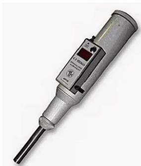
Прибор предназначен для неразрушающего оперативного контроля прочности бетона, железобетона и конструкций в соответствии с **ГОСТ 22690-88** «Определение прочности механическими методами неразрушающего контроля».
