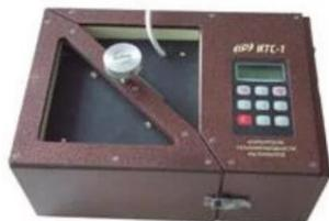
**Прибор предназначен** для оперативного определения теплопроводности и термического сопротивления широкого спектра строительных и теплоизоляционных материалов стационарным методом по ГОСТ 7076-99.
