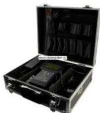
**Коэрцитиметр *предназначен*** для неразрушающего локального контроля качества термической, термомеханической или химико-термической обработок, а так же определения твердости и механических свойств деталей из ферромагнитных материалов при наличии корреляционной связи между контролируемым и измеряемым параметрами. Прибор может быть использован для разбраковки металлов по маркам стали и контроля поверхностных слоев ферромагнитных материалов.
