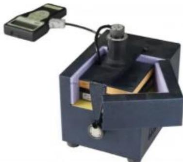
Приборы типа ИТП-МГ4 *предназначены* для определения теплопроводности и термического сопротивления строительных материалов, а также материалов, предназначенных для тепловой изоляции промышленного оборудования и трубопроводов при стационарном режиме по **ГОСТ 7076** и методом теплового зонда по **ГОСТ 30256**.
