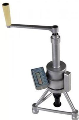
Приборы ПОС-50МГ4 *предназначены* для неразрушающего контроля прочности бетона методом отрыва со скалыванием и скалывания ребра по **ГОСТ 22690**.
