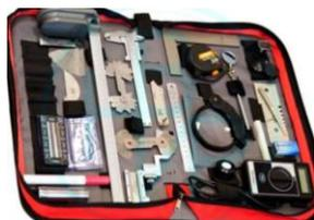
**Комплекты ВИК используются** для визуального и измерительного контроля основного металла и сварных соединений на стадиях входного контроля, подготовки к сварке и оценки их состояния в ходе эксплуатации. Для специалистов различных отраслей промышленности разработаны наиболее подходящие комплекты. На сегодняшний день разработаны следующие комплектации наборов ВИК:
