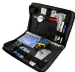
**Комплекты ВИК применяются** для визуального и измерительного контроля основного металла и сварных соединений на стадиях входного контроля, подготовки к сварке и оценки их состояния в ходе эксплуатации.
