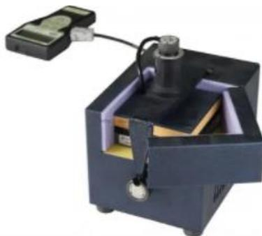
Прибор ИТП-МГ4 «Зонд» *предназначен для оперативного определения теплопроводности строительных материалов, а также материалов, предназначенных для тепловой изоляции промышленного оборудования и трубопроводов методом теплового зонда по ГОСТ 30256.*
