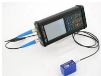
Ультразвуковой дефектоскоп ПЕЛЕНГ-115 **предназначен** для контроля продукции на наличие дефектов типа нарушения сплошности и однородности материалов готовых изделий, полуфабрикатов и сварных (паяных) соединений, а также для измерения глубины и координат залегания дефектов.
