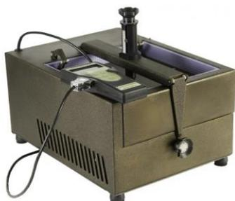
Приборы типа **ИТП-МГ4** *предназначены* для определения теплопроводности и термического сопротивления строительных материалов, а также материалов, предназначенных для тепловой изоляции промышленного оборудования и трубопроводов при стационарном режиме по **ГОСТ 7076** и методом теплового зонда по **ГОСТ 30256**.
