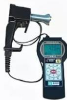
Измеритель прочности строительных материалов **ИПМ-1Э предназначен** для контроля прочности бетона на сжатие неразрушающим ударно-импульсным методом по ГОСТ 22690-88, а также для контроля прочности раствора и строительной керамики, на строительных предприятиях и при обследовании зданий и сооружений.
