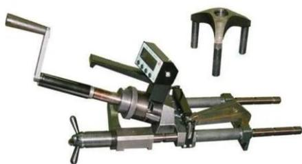
Приборы типа ПОС-МГ4 *предназначены* для неразрушающего контроля прочности бетона методом отрыва со скалыванием и методом отрыва стальных дисков по ГОСТ 22690.
