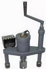
Приборы типа ПОС-МГ4 *предназначены* для неразрушающего контроля прочности бетона методом отрыва со скалыванием по **ГОСТ 22690**.
