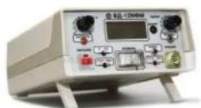
Прибор **предназначен** для обнаружения поверхностных трещин в деталях из ферромагнитных и немагнитных сталей и сплавов.
