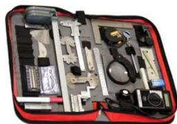
Комплект *предназначен* для визуального измерительного контроля, в соответствии с ПНАЭ Г-7-016-89 «Визуальный и измерительный контроль»
