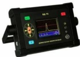
**Вихретоковый дефектоскоп ВД-70 предназначен** для контроля продукции из ферромагнитных и немагнитных металлов и сплавов на наличие поверхностных дефектов типа трещин, оценки их глубины и определения местоположения.
