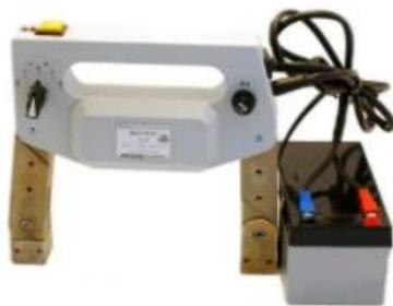
Прибор **предназначен** для выявления поверхностных дефектов типа нарушения сплошности металла магнито-порошковым методом на локальных участках крупногабаритных деталей путем создания приложенного постоянного магнитного поля. Применяется для выявления дефектов в ферромагнитных деталях, относительная магнитная проницаемость которых не менее 40.
