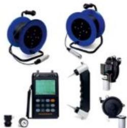
**ПУЛЬСАР-2.2 "ДБС" предназначен** для ультразвукового контроля однородности и сплошности бетона в сваях и фундаментах глубокого заложения (в т.ч. в буронабивных и бетонных сваях, сваях по технологии непрерывного проходного шнека). Применим к фундаментам типа "стена в грунте", барретам, плотинам. Дополнительно прибор позволяет проводить технологический и объектовый контроль прочности бетона по **ГОСТ 17624** и кирпича по **ГОСТ 24332**, а также оценивать класс бетона по **ГОСТ 18105**.
