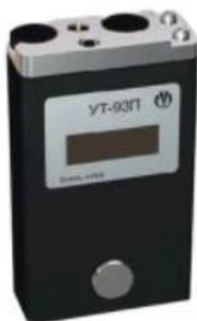
Толщиномер ультразвуковой УТ-93П/1 *предназначен* для измерения толщины изделий из конструкционных металлических сплавов, при одностороннем доступе к ним.
