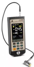
Ультразвуковой морозостойчивый (от -30°C до +50°C) **толщиномер А1208** с большим TFT дисплеем, встроенным Li-Ion аккумулятором и памятью на 50 000 результатов измерений, **предназначен** для измерения толщины изделий из металла, пластика, стенок труб, а также изделий с высоким затуханием ультразвука.
