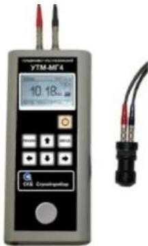
**Толщиномер УТМ-МГ4 предназначен** для измерения толщины стенок труб, котлов, сосудов, обшивок судов, литья, листового проката и других изделий из чёрных и цветных металлов. Поверхности изделий могут быть как гладкими, так и грубыми, корродированными с шероховатостью до  $Rz160$  и радиусом кривизны от 5 мм.
