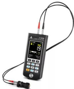
Прибор **предназначен** для измерений толщины стенок металлических и пластиковых труб, котлов, сосудов, обшивок с шероховатостью поверхностей до Rz160 и радиусом кривизны от 3 мм.
