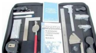
Комплекты ВИК *применяются* для визуального и измерительного контроля основного металла и сварных соединений на стадиях входного контроля, подготовки к сварке и оценки их состояния в ходе эксплуатации.
