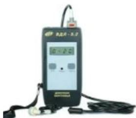
**Вихретоковый дефектоскоп ВДЛ-5.2 предназначен** для обнаружения и оценки глубины поверхностных несплошностей и трещин в стальных конструкциях и деталях (в частности, в рабочих лопатках конденсационных и теплофикационных турбин), трещин в металлоконструкциях, сварных швах и т.п. Например, контролю могут подвергаться лопатки в начальной зоне фазового перехода, а также все лопатки, работающие в области влажного пара. Прибор может быть использован для контроля углеродистых сталей широкого класса.
