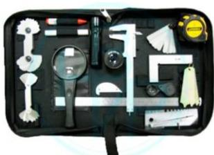
**Комплекты ВИК применяются** для визуального и измерительного контроля основного металла и сварных соединений на стадиях входного контроля, подготовки к сварке и оценки их состояния в ходе эксплуатации.
