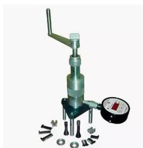
**Прибор для испытания бетона ПИБ предназначен** для определения прочности бетона методом отрыва со скалыванием по **ГОСТ 22690-2015**.
