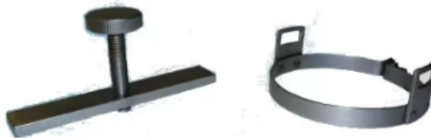
Приспособление **ПВС** предназначено для насыщения грунтов водой без возможности набухания перед испытанием на сдвиг.
