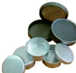
**Предназначена** для отбора и транспортировки и хранения проб грунта и прочих веществ, неагрессивных к металлу бьюксы.
