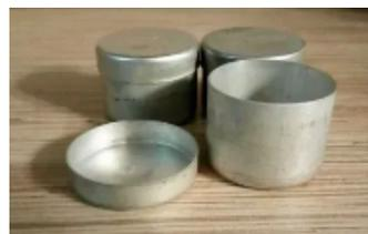
**Предназначена** для отбора транспортировки и хранения проб грунта и прочих веществ, неагрессивных к металлу бюксы.
