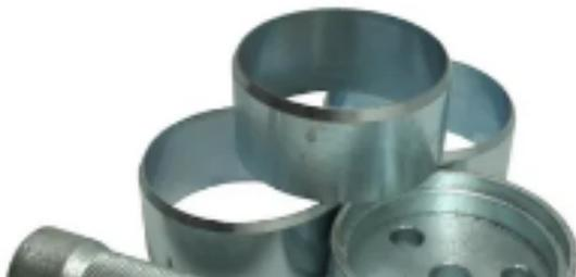
**Пробоотборник ПГ** предназначен для отбора пробы песчаных, пылевато-глинистых грунтов с целью определения их плотности.
