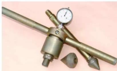
**Предназначен** для испытаний слабых грунтов методом зондирования согласно **ГОСТ 19912-2001** "Грунты. Методы полевых испытаний статическим и динамическим зондированием".
