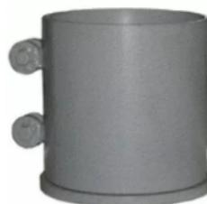
Для изготовления бетонных образцов-цилиндров 150x150 мм, предназначенных для испытаний на водонепроницаемость по ГОСТ 12730.5-84.
