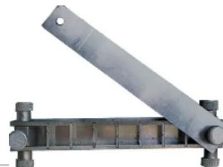
Преназначена для изготовления бетонных образцов 20x20x20 мм
