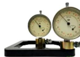
Прибор, для измерения отклонений **НПЛ-1** предназначен для определения отклонений опорных граней образцов бетона от плоскости по **ГОСТ 10180**.
