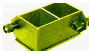
Формы типа ФК предназначены для изготовления контрольных образцов раствора и бетона, применяемых для определения его физико-технических характеристик - определения предела
