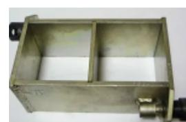
Изготовление бетонных и растворных кубов, служащих для определения предела прочности цемента на сжатие.
