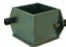
Формы типа ФК предназначены для изготовления контрольных образцов раствора и бетона, применяемых для определения его физико-технических характеристик - определения предела прочности тяжелого бетона на сжатие.(по ГОСТ 10180) и других испытаний.
