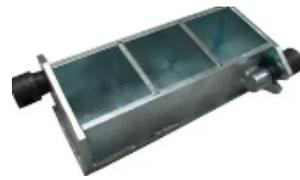
Формы типа ФК предназначены для изготовления контрольных образцов раствора и бетона, применяемых для определения его физико-технических характеристик - определения предела прочности тяжелого бетона на сжатие.(по ГОСТ 10180) и других испытаний.
