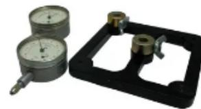
Прибор, для измерения отклонений **НПЛ-1** предназначен для определения отклонений опорных граней образцов бетона от плоскости по **ГОСТ 10180**.
