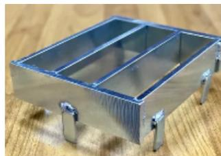
Применяется с трёхгнездовой формой 40x40x160, для предотвращения разбрызгивания смеси во время вибрирования на виброплощадке.
