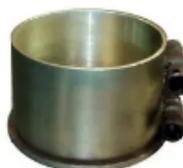
Для изготовления бетонных образцов-цилиндров 150x150 мм, предназначенных для испытаний на водонепроницаемость по ГОСТ 12730.5-84.
