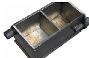
Формы типа ФК предназначены для изготовления контрольных образцов раствора и бетона, применяемых для определения его физико-технических характеристик - определения предела прочности тяжелого бетона на сжатие.(по ГОСТ 10180) и других испытаний.
