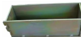
Формы-призмы типа ФП предназначены для изготовления контрольных образцов раствора и бетона, служащих для определения его физико-технических характеристик - определения предела прочности тяжелого бетона на сжатие. (по ГОСТ 10180) и других испытаний.
