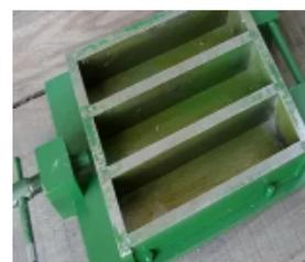
Предназначена для изготовления образцов балочек, по которым определяются в лабораториях качественные хар-ки цемента (в соответствии с ГОСТ 310.4-81).
