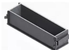
Изготовление бетонных балочек, служащих для определения предела прочности тяжелого бетона на сжатие.
