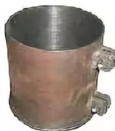
Форма ФЦ150x300 предназначена для изготовления бетонных образцов-цилиндров 150x300 мм, по ГОСТ 22685-89, применяемых для определения прочности на сжатие и на растяжение при изгибе и раскалывании (ГОСТ 10180-90).
