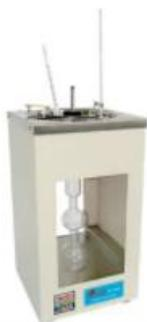
**Вискозиметр предназначен** для определения условной вязкости (времени истечения) жидких сред, дающих непрерывную струю в течение всего времени истечения.
