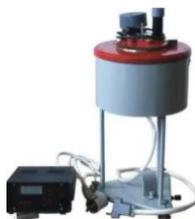
**Вискозиметр предназначен** для обеспечения методики ГОСТ 6258 в лабораториях НПЗ, НИИ, нефтебазах и других организациях, использующих нефтепродукты.
