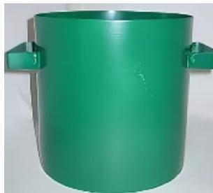
Сосуд **МП-5л (ОМВ)** предназначен для определения насыпной плотности и пустотности щебня (гравия) по **ГОСТ 9758-86, ГОСТ 8269.0-97**, определение средней плотности, водоотделения, расслаиваемости и раствооротделения бетонной смеси по **ГОСТ 10181-2000**.
