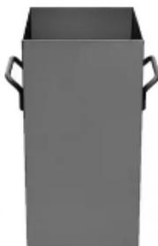
Форма 200х200х400 применяется при определении степени уплотняемости бетонной смеси по **ГОСТ 10181-2014**.
