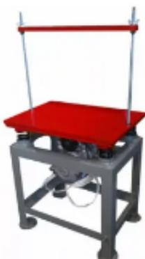
Виброплощадка предназначена для уплотнения бетонных и растворных смесей при:
