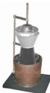
Жёсткость бетонной смеси характеризуется временем вибрации в секундах, необходимым для выравнивания и уплотнения
