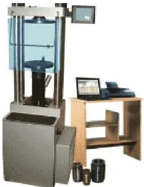
Испытательный пресс типа ИП-1А предназначен для испытания строительных материалов по ГОСТ 8462, ГОСТ 6996, ГОСТ 14019, ГОСТ 10180, ГОСТ 26798.2-96, ГОСТ 310.4-81.
